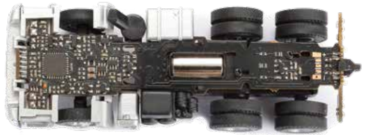
La platine sert de châssis
