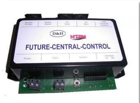
Fig. 3.34 Le système digital Future-Central-Control
