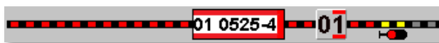
Fig. 4.13 Adresse digitale et N° série dans les étiquettes de suivi de train
