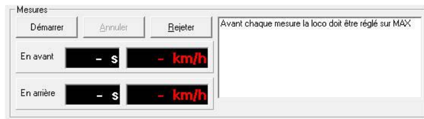
Fig. 4.36 Les valeurs mesurées sont affichées ici au cours d'une mesure
