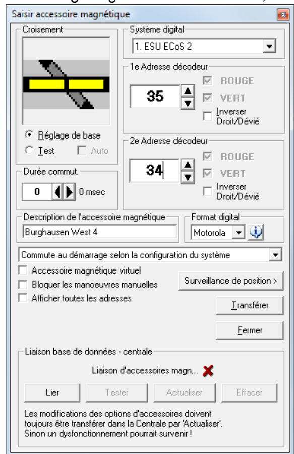
Fig. 5.41 Adressage de la traversée de jonction double
