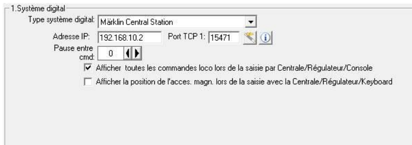
Fig. 3.58 Les réglages pour une Märklin Central Station (60212)
