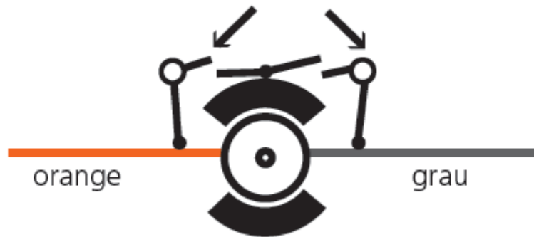
Abbildung 15: 5-poliger Märklin® Hochleistungsmotor
